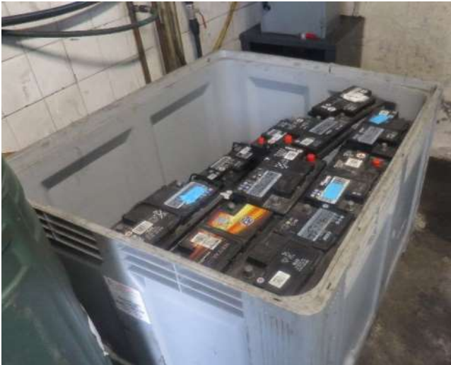
Almacenamiento de baterías usadas sobre cubeto. Consejería de Transición Ecológica, Industria y Desarrollo Económico. Gobierno del Principado de Asturias.
