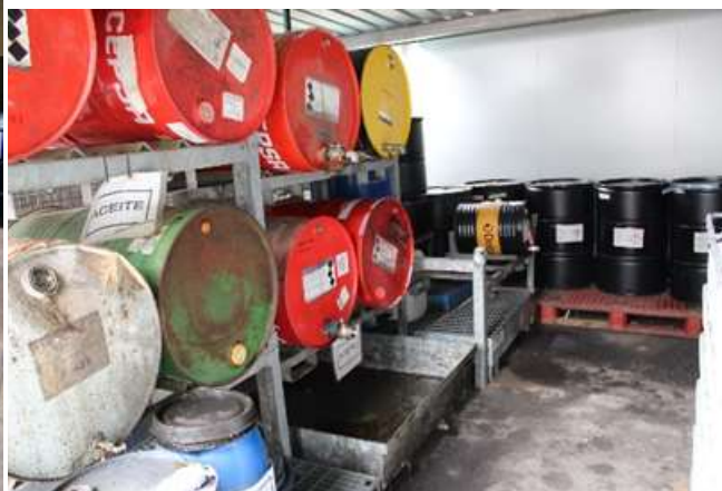
Almacén de residuos en área habilitada, segregado e identificado (aceite usado). Consejería de Transición Ecológica, Industria y Desarrollo Económico. Gobierno del Principado de Asturias.
