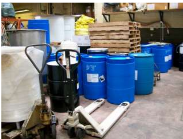
Almacenamiento incorrecto de residuos: sin segregación, identificación y sin medidas anti vertido. "Creative commons" por TLazzo licencia bajo CC BY 3.0 DEED.
