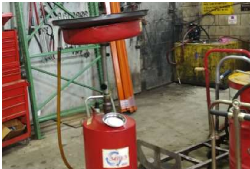
Ejemplo de sistema de recogida de aceites usados en talleres de vehículos. "Creative Commons" de dominio público (CC0 1.0 DEED).
