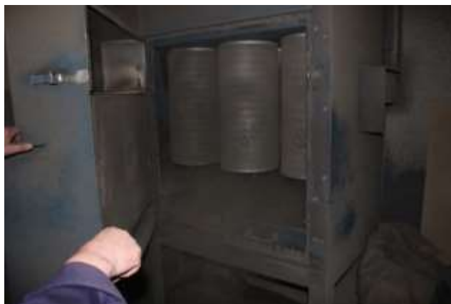
Sistema de filtros de zona de lijado con aspiración. Consejería de Transición Ecológica, Industria y Desarrollo Económico, Gobierno del Principado de Asturias.
