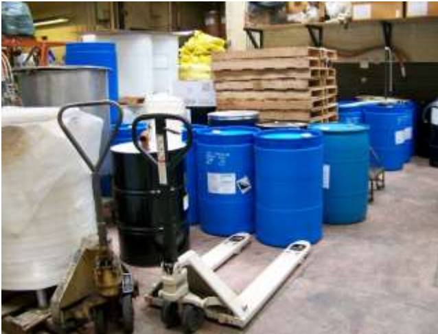
Almacenamiento de residuos sin segregar, identificar y sin medidas anti vertido. “Creative commons” por TLazzo licencia bajo CC BY 3.0 DEED.
