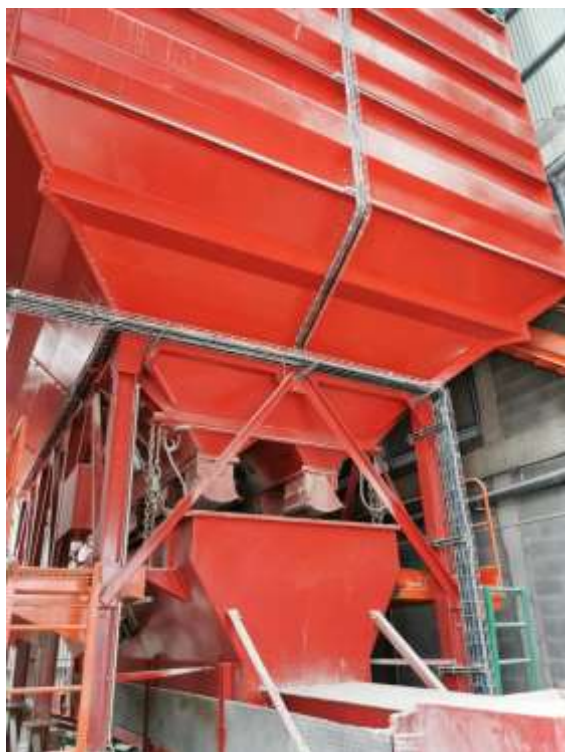
Tolva de descarga a amasadora. Consejería de Transición Ecológica, Industria y Desarrollo Económico, Gobierno del Principado de Asturias (Hormigones Pelayo).
