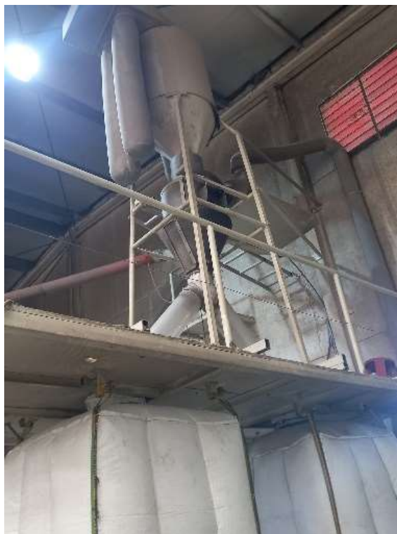
Filtro de mangas y ciclón en molienda. Consejería de Transición Ecológica, Industria y Desarrollo Económico, Gobierno del Principado de Asturias (Hormigones Pelayo).
