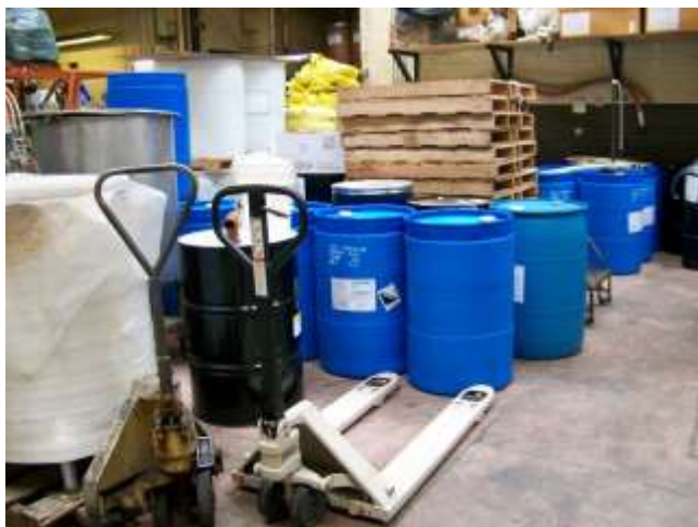
Almacenamiento de residuos sin segregar, identificar y sin medidas anti vertido. “Creative commons” por TLazzo licencia bajo CC BY 3.0 DEED.
