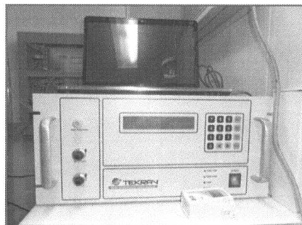
Figura 2. Analizador de mercurio gaseoso total en el interior de la estación de medida de contaminantes atmosféricos
